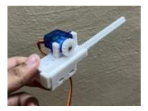
Fig. 9. Linear actuator
